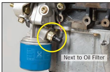
3.5L SIGMA 2002 - 2005 Sedona (GQ) 2003 - 2006 Sorento (BL) 2004 - 2006 Amanti (GH) 11.6 PSI @ Idle
